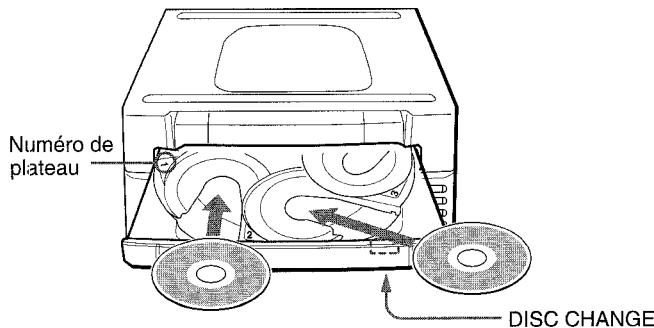
Pour charger de trois à cinq disques, appuyez sur **DISC CHANGE** pour faire tourner les plateaux après avoir posé deux disques. Posez le disque suivant sur le plateau vide. A chaque pression sur **DISC CHANGE**, les plateaux tournent et un nouveau disque peut être mis en place.
